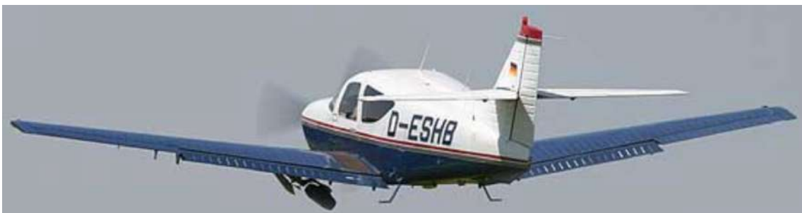
Figura 1 Il Rockwell Commander 114B fotografato in partenza dall'aeroporto di LIAF Foligno verso l'aviosuperficie di Castiadas (fonte: http://www.aformadidea.com/aeroporto_di_foligno_Archivio_News2.asp ) è un aeromobile quadriposto a carrello retrattile dotato di un motore Lycoming IO-540-T4B5 da 260hp dal peso massimo al decollo di 1474 kg (fonte: Relazione ANSV)
